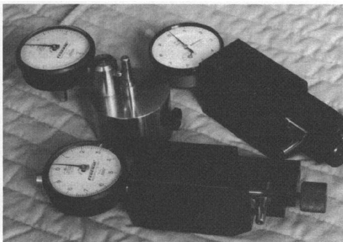
Инструменты для обточки Пинделл (сзади), Жаусо (спереди), приспособление для проверки толщины стенок (биения) шейки гильзы
