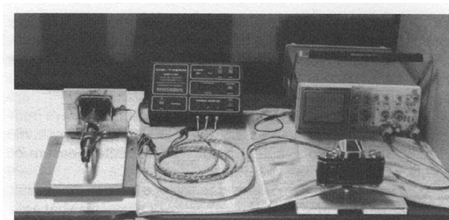
Установка для измерения давления/удара
