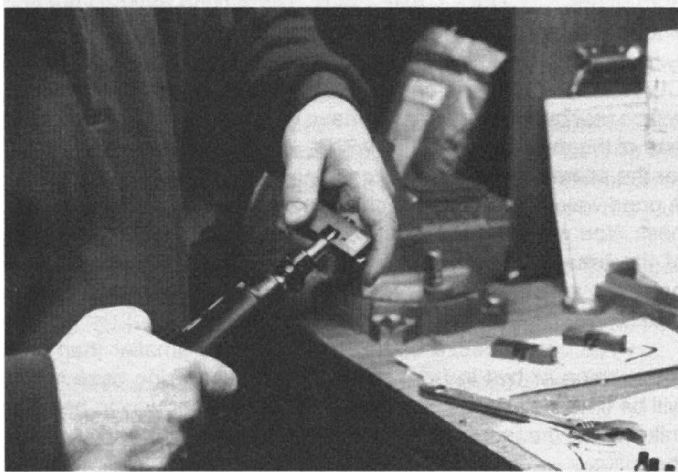
Использование беспроводной отвертки для обточки шеек гильз. Обратите внимание на то, что Кевин облокотил руку на тиски. Инструмент будет вибрировать. Немного практики здесь не повредит.
